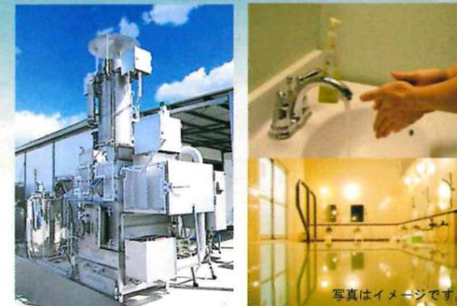
小型焼却炉TG-49のごみ焼却熱を給湯設備の熱源として利用するサーマルリサイクルシステム 給湯能力は 60℃のお湯を毎時 1.5m<sup>3</sup>以上 老人ホームや病院など、常時大量のごみが発生し、入浴設備のある事業所などに最適です。
