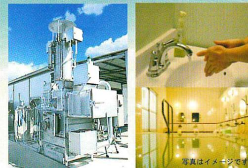
小型焼却炉 TG-49 のごみ焼却熱を給湯設備の熱源として利用するサーマルリサイクルシステム
